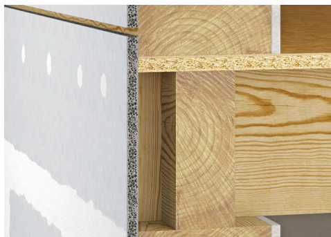
figur 1: Pladestrimmel med korrekt påført armeringsbånd og -klæber.
