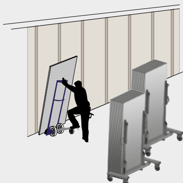
Figur 1d: Plader rejses op af underkonstruktion vha. montagevogn og befæstiges.
